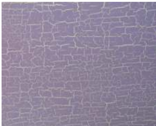
Sovraverniciato a pennello con idropittura (con un contenuto in resina del 20%) diluita al 10%
