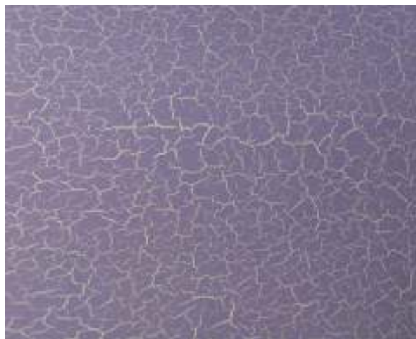
Sovraverniciato a rullo con idropittura (con un contenuto in resina del 20%) diluita al 10%
